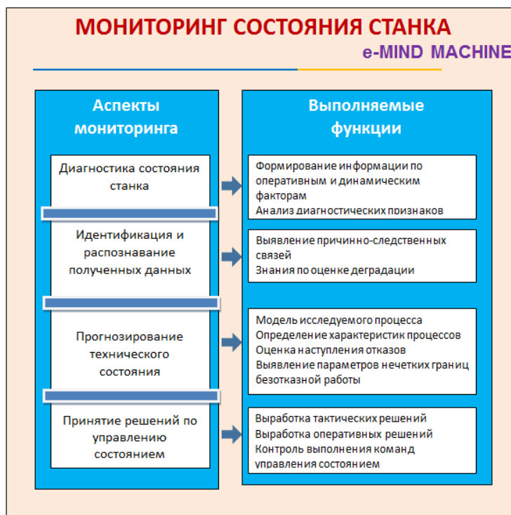
Рис. 2. Структура блока мониторинга состояния МОС
